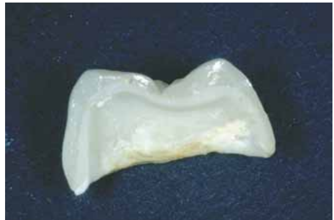
Abbildung 4 Seitenansicht des Teils einer vollständig frakturierten Procera AllCeram-Krone.
